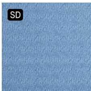
Vzorek SD byl vyčištěn čisticími prostředky obsahujícími chlór - barva zůstává nezměněna.
